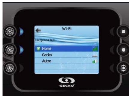
Cuando el módulo in.touch es conectado a una red Wi-Fi una señal verde aparece en el menú Wi-Fi, y el nombre de la red se visualiza en el menú de configuración.
