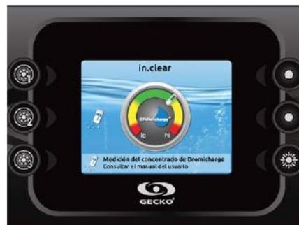
Cuando se añada BromiCharge, el indicador se moverá lentamente a la derecha. Cuando se añada agua al spa, el indicador se moverá a la izquierda. Para alcanzar un nivel adecuado de BromiCharge, encienda las bombas y añada la cantidad indicada de BromiCharge\*\*. Espere 5 minutos para que el indicador se ajuste antes de añadir más producto.
